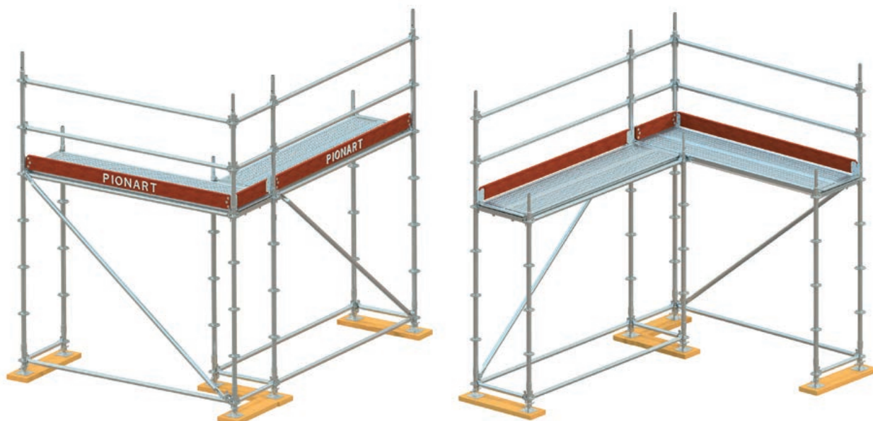
Rys. 46. Montaż narożników z wykorzystaniem rozwiązania składającego się z 3 stojaków
