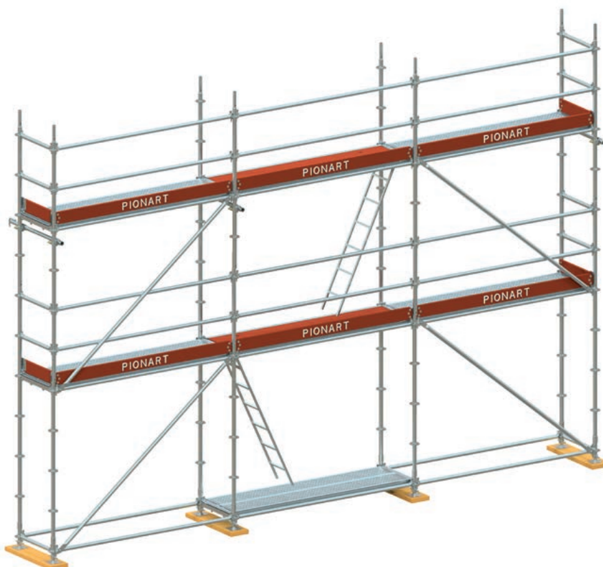
Rys. 25. Komunikacja na rusztowaniu realizowana za pomocą pomostów komunikacyjnych ze zintegrowaną drabinką
