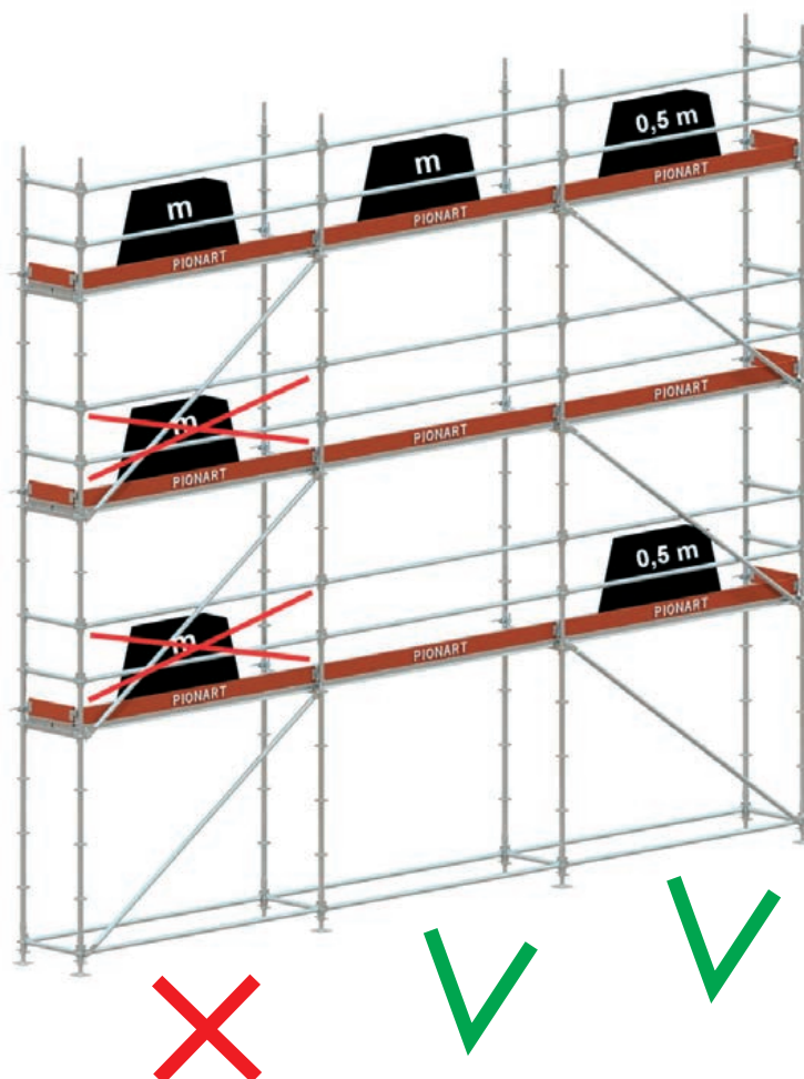
Rys. 2. Dopuszczalne obciążenie rusztowania
