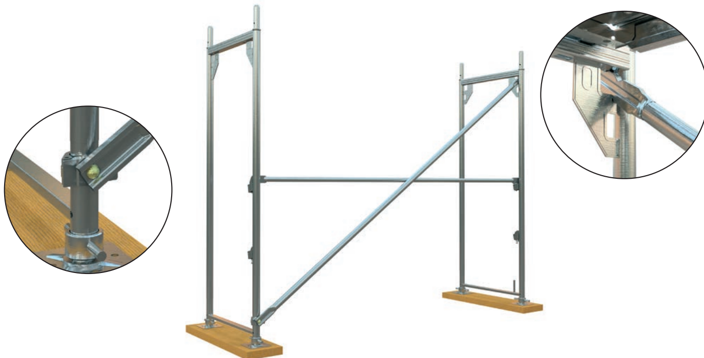
Rys. 4. Montaż stężenia ukośnego pierwszego pola
