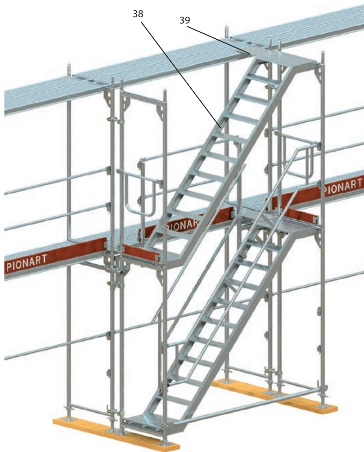
Rys. 44. Montaż klatki schodowej jednobiegowej – etap V
