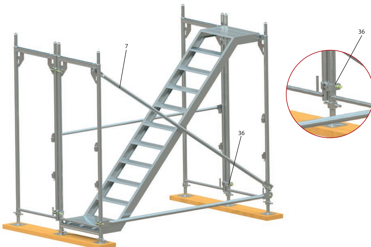
Rys. 54. Montaż klatki schodowej dwubiegowej – etap II
