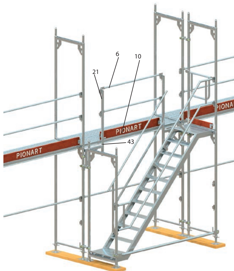
Rys. 42. Montaż klatki schodowej jednobiegowej – etap III
