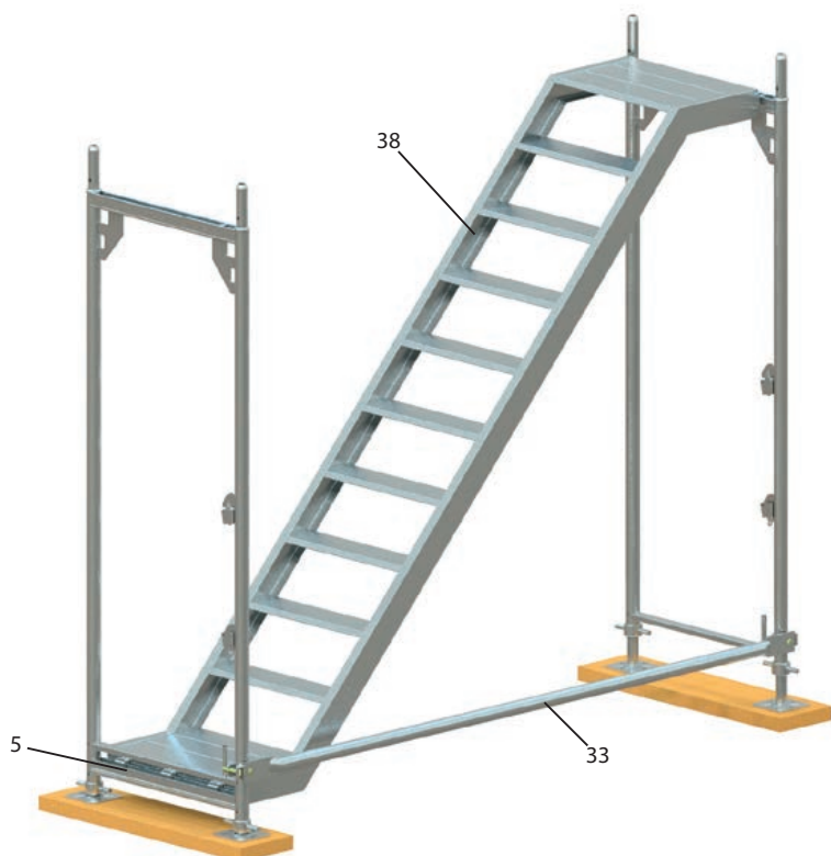
Rys. 47. Montaż klatki schodowej jednobiegowej z konsolą 0,73 m – etap I
