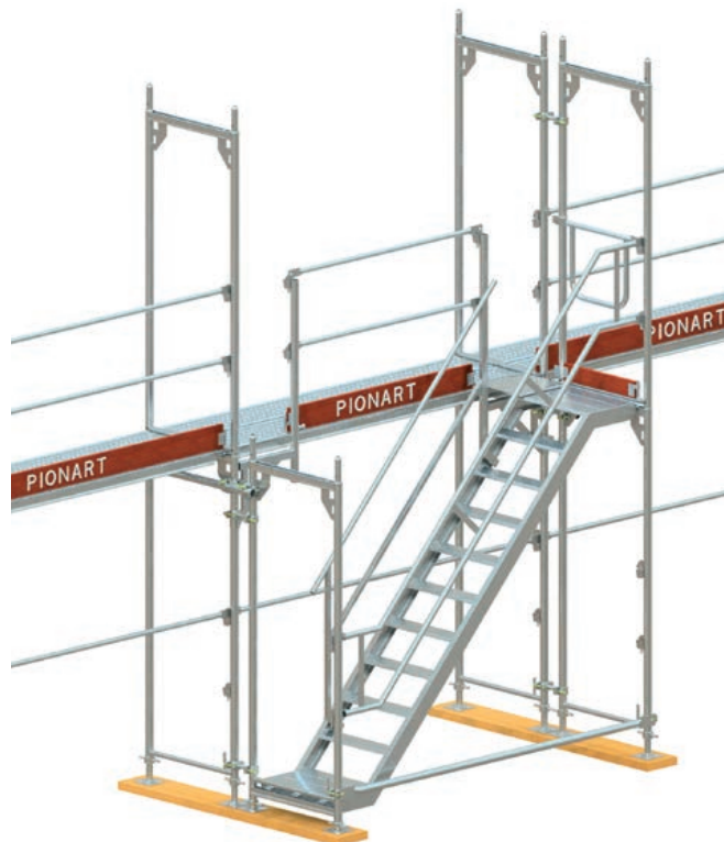
Rys. 43. Montaż klatki schodowej jednobiegowej – etap IV
