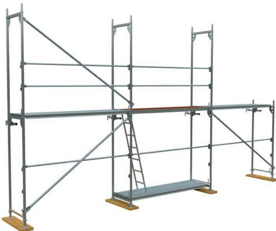
Rys. 12. Montaż stężenia ukośnego drugiej kondygnacji
